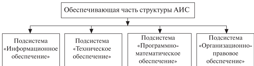
Рис. 3.1. Структура обеспечивающей части АИС
