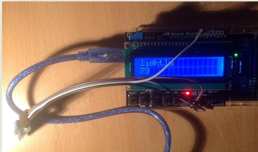
Считать значения, поступающие на последовательный порт, позволяет модуль pySerial<sup>67</sup>. Исходный текст на языке Python,читывающий показания, поступающие от датчика освещенности:
