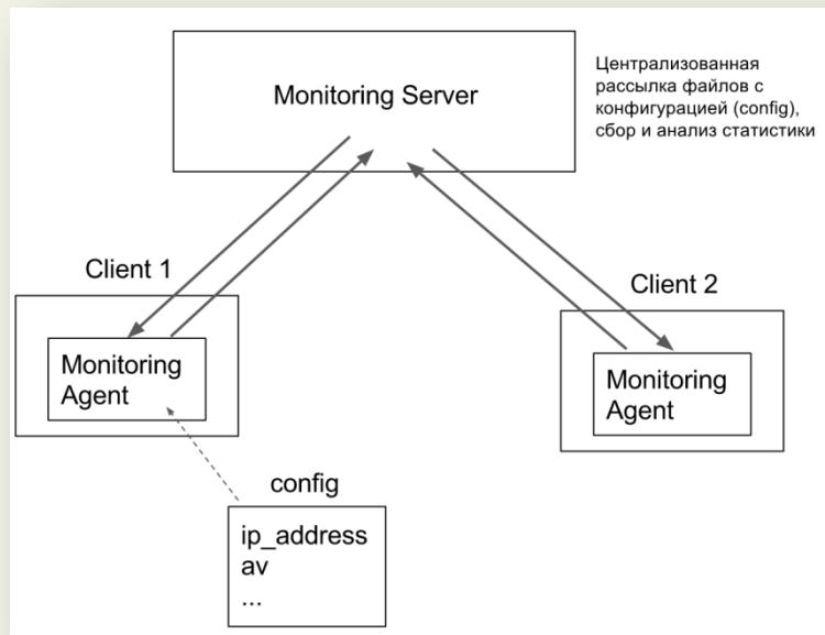
Каждый хост (операционная система на выбор разработчика) содержит программу-агента, который собирает информацию о текущем состоянии системы, например, контроль запуска определенных служб (контролируемые службы выбираются на усмотрение разработчика, можно реализовать выбор службы для мониторинга через конфигурационный файл). Необходимо задействовать максимальные возможности Python для работы с операционными системами.
